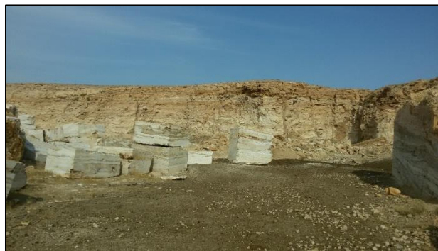
شکل ۶- متروکه شدن معدن به دلیل توسعه شکستگی‌های کششی و برشی، جهت دید (NE)
