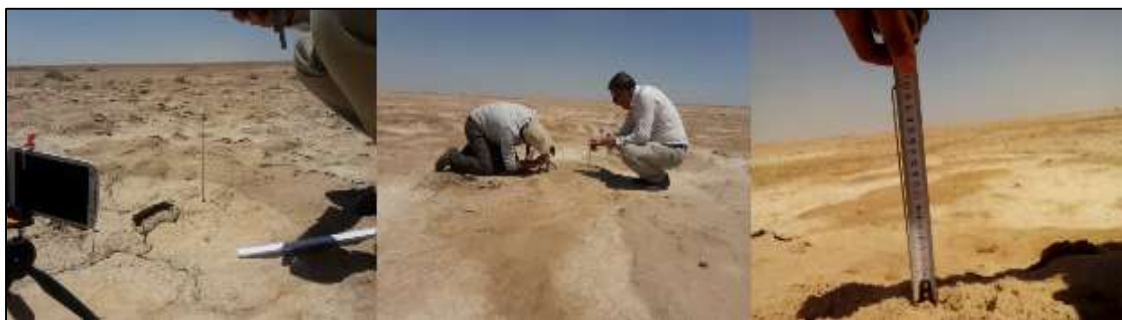
شکل ۳- عملیات میدانی و اندازه‌گیری ارتفاع شاخص‌های کاشته در محدوده تالاب هورالعظیم
