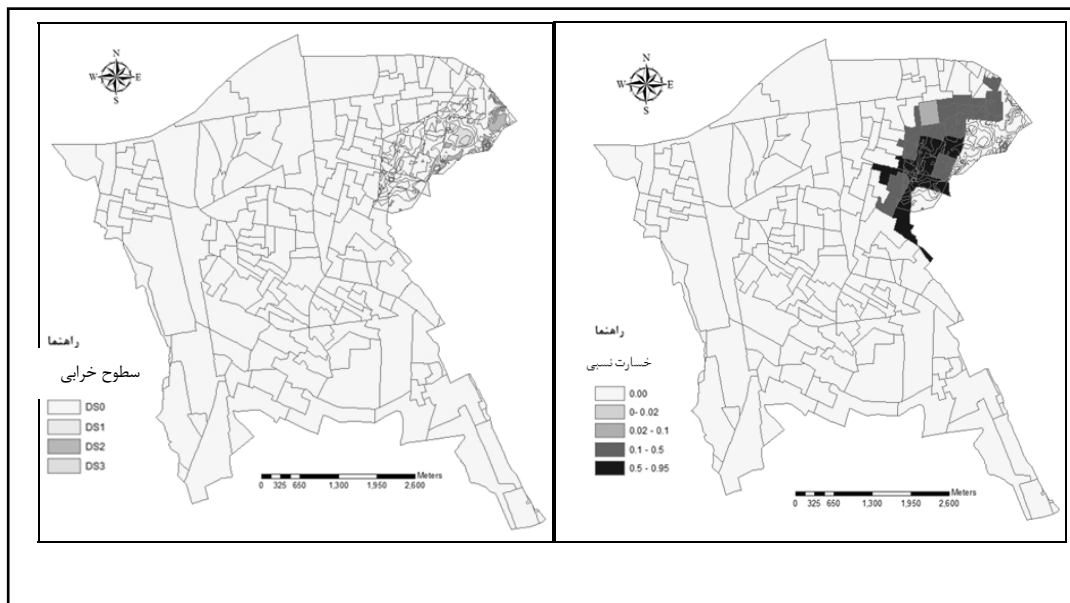
شکل ۹ سطوح خرابی مختلف در اثر سیل شکل ۱۰ خسارت‌های ناشی از سیل در منطقه مورد مطالعه
