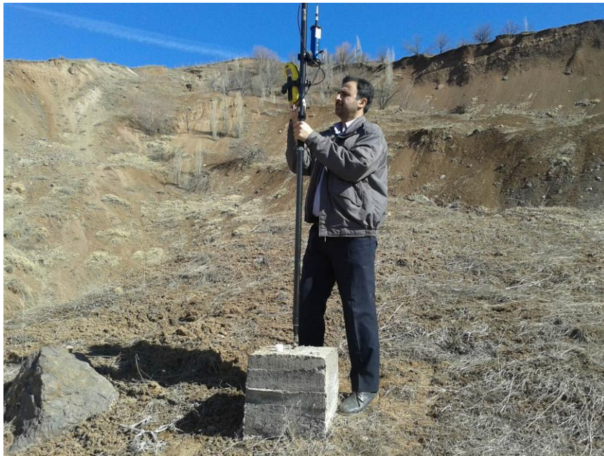
شکل ۲ ایستگاه شاهد و تعیین مختصات آن با جی‌پی‌اس دوفرکانسه به روش RTK
